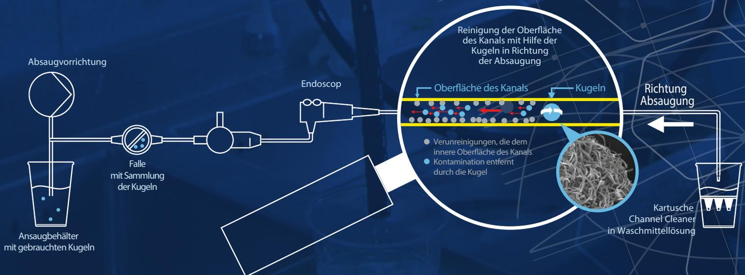
Effektive, sichere, wiederholbare und schnelle Kanalbürstung, dank der Mikrokugeln, die aus mehr als einer Million Fasern mit einer Größe von nur wenigen Mikrometern bestehen.
